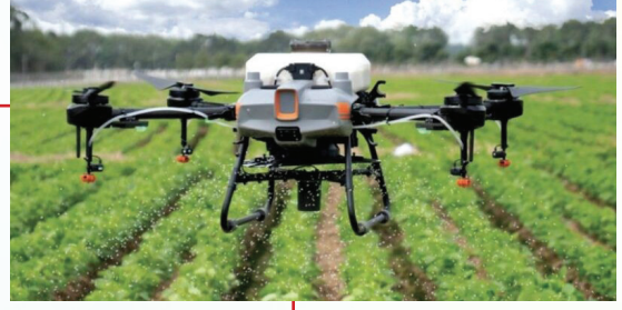
Şekil 2: Ürün Kontrolü Yapan İHA
